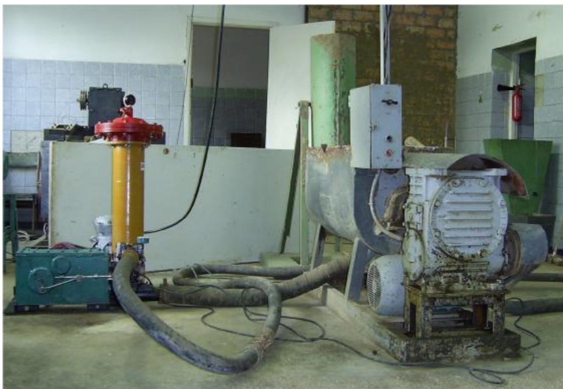
Рис. 1. Експериментальна установка для визначення об'ємного ККД розчинонасоса: а – конструктивна схема; б – зовнішній вигляд стенда
