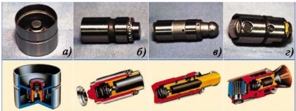
Рис. 2. Типи гідравлічних компенсаторів проміжку: a – гідроштовхач; б – гідроопора;
