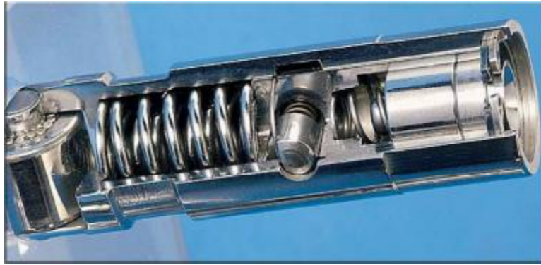
Рис. 4. Конструкція штовхача з відключенням двигуна Chrysler Hemi
