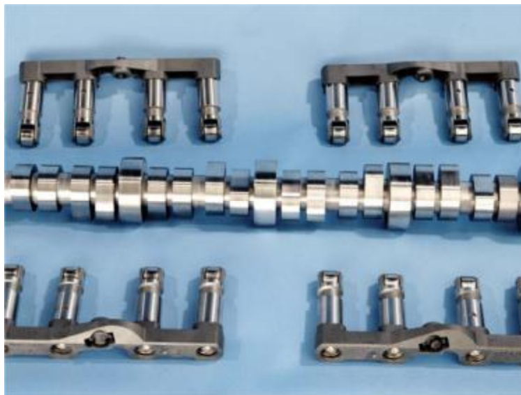
Рис. 3. Розподільний вал та штовхачі двигуна Chrysler Hemi
