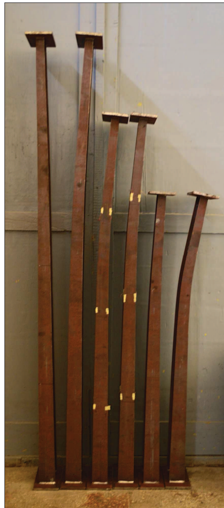
Рисунок 2 – Погини стержнів після випробування
