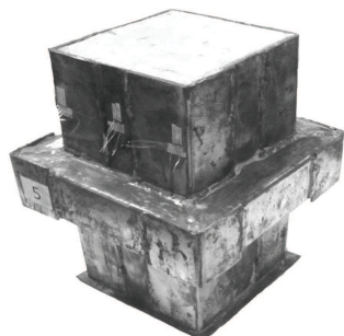
Рисунок 2 – Внешний вид сталебетонного элемента
