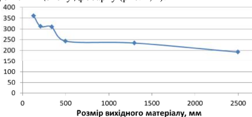
Рис. 1. Регресійна крива питомої металоємності щоківих дробарок, кг/м³/год
