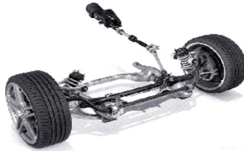
Рис. 3. Рульовий механізм та рульовий привід
