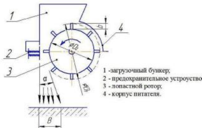
Рис. 4. Принципиальная схема ротора бетоноукладчика
