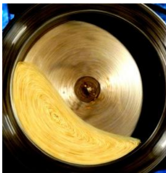
Рис. 4. Розрахункова (а) та експериментальна (б) картини руху завантаження при \psi_\omega=0,4 , \kappa=0,3 , d/D=0,01 у гладкій камері
