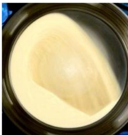
Рис. 7. Розрахункова (а) та експериментальна (б) картини руху завантаження при \psi_{\omega}=1,05 , \kappa=0,45 , d/D=0,0024 у гладкій камері
