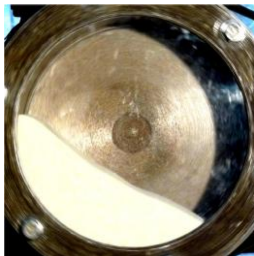
Рис. 3. Розрахункова (а) та експериментальна (б) картини руху завантаження при \psi_\omega=0,1 , \kappa=0,25 , d/D=0,0024 у гладкій камері
