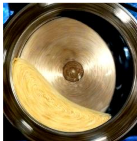
Рис. 11. Картини руху завантаження при зовнішньокамерному двостадійному подрібненні в барабанних млинах: а – попередній грубий помел; б – остаточний тонкий помел
