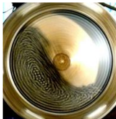
Рис. 5. Розрахункова (а) та експериментальна (б) картини руху завантаження при \psi_{\omega}=0,75 , \kappa=0,35 , d/D=0,026 у гладкій камері
