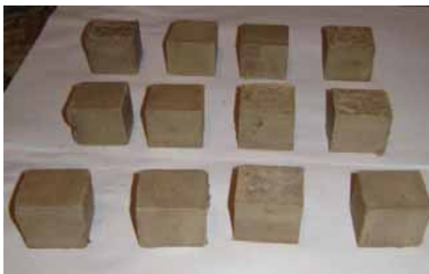
Рис. 1 – Зразки ґрунтоцементу для лабораторних випробувань
