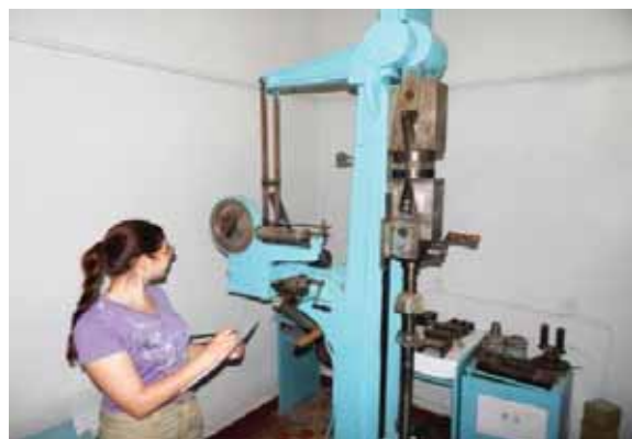
Рис. 2 – Випробування зразків ґрунтоцементу на міцність
