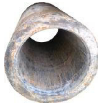
Рисунок 1 – Види зношення циліндрової втулки бурового насоса: 1 – абразивно-втомне; 2 – абразивне; 3 – гідроабразивне; 4 – корозійно-механічне, ускладнене кавітаційним зношенням
