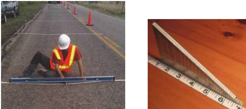
Рисунок 5 – Використання рейки довжиною 6 футів і клинового промірника
