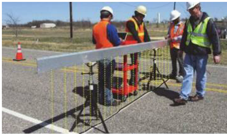
Рисунок 6 – Вимірювання колійності з використанням лазерної системи Leica
