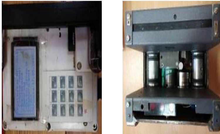
Рисунок 10 – Вимірювальна каретка приладу (вигляд зверху і знизу)
