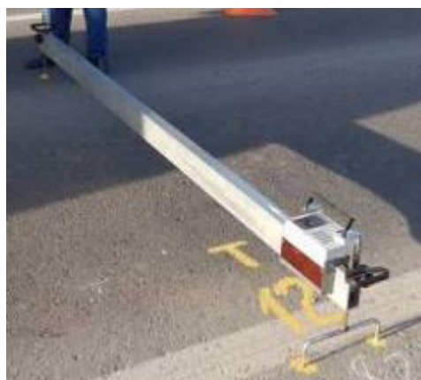
Рисунок 14 – Приклад позначення місця встановлення опор приладу
